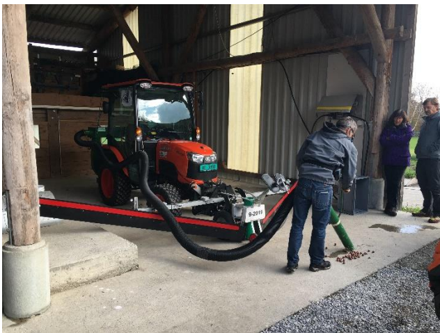
Gauch arbeitet an einer Erweiterung der Nussaufsaugmaschine der Firma Chianchia.
