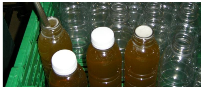
Randvoll-Füllung bei PET Flaschen und sofortiger Verschluss
