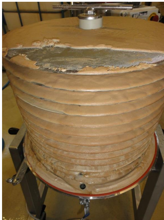
Kieselgur-Anschwemmfilter nach der Filtration – braune Trubstoffe werden von Kieselgur zurückgehalten.
